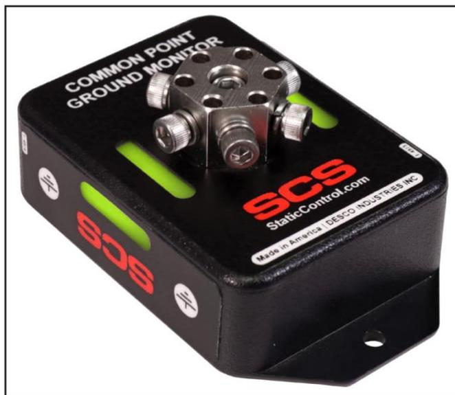
コンセントの接地ラインはニュートラルラインとの間の電圧を測定することでテストされます。通常、AC の数ボルトがニュートラルラインに誘導されます。本製品が数ボルトしか測定しない場合は、接地ラインからニュートラルラインへのインピーダンスが低く、接地ラインが ESD 接地ポイントとして適切であることを示します。接地とニュートラルの間で数ボルト以上の電圧が測定された場合は、お互いが関連していない状態か、コンセントや関連の配線が緩んでいないか確認する必要があります。この場合、モニターはアラーム音が鳴り、赤 LED が点灯しますので、適切に接続されるまでは ESD 接地ポイントとして使用しないでください。
