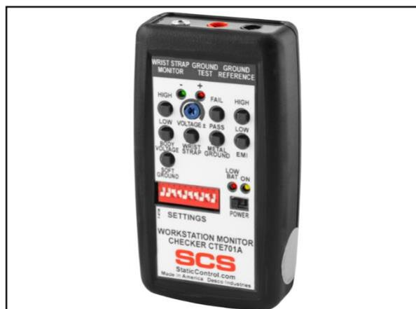
この校正器でデュアルリストストラップの監視の適切な操作を検証することもできます。3.5 mm テストケーブルを校正器とモニターのオペレータージャック両方に接続します。この時点では、モニターは不合格を示します。「Wrist strap」の「Pass」ボタン (リストストラップ用合格スイッチ) を押します。モニターは良い接続を示します。「Pass」ボタンを押したまま「Bode voltage」の「High」ボタンを押します。リストストラップ用の赤 LED が点滅します。
