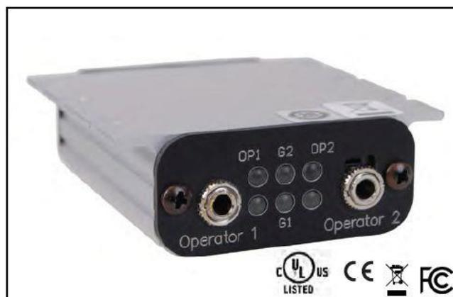
**接地インピーダンスを監視** — 1つまたは2つの製造製品に接続されている1つまたは2つ別々の経路上の接地インピーダンスを常時監視します。アラームレベルはすべての経路で同じ設定になります。
