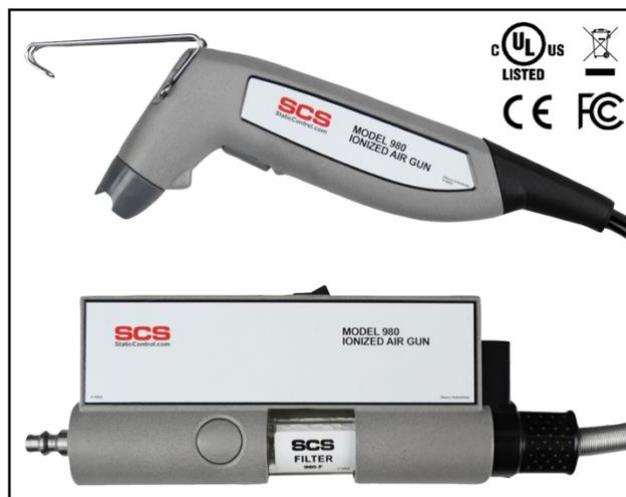
本製品は、ESD 協会のイオナイザー規格 ANSI/ESD-S3.1 に則ってテストした場合、15cm の距離と 30psi の入口圧力で、1 秒以内に±1000V の静電気を±100V に低減することができます。オフセット電圧は 15cm の距離で±30V 以内です。
