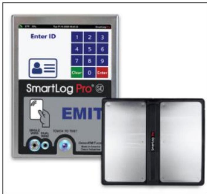
5 インチのカラータッチパネルはオペレーター識別の際のユーザーインターフェースを容易にし、テスト結果をわかりやすく表示します。作業者の平均テスト時間は 2 秒です。もしネットワークエラーが起こったとしても内蔵メモリーがテスト結果を記録するので、テストの継続を可能にします。ネットワーク接続が復元すると、すべてのテスト結果がデータベースへとダウンロードされます。
