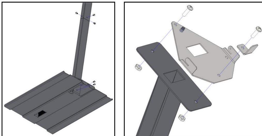
2. テスター設置用ブラケットの上下の穴を台座の2つの穴に合わせます(右上)。ケーブルポートカバーをブラケットと台座両方の下の穴に合わせます。平ネジ2本とナット2個を使って設置用ブラケットとケーブルポートカバーを台座に固定します。
