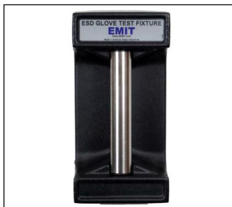
チャージデバイスモデル(CDM)のESD 損傷を防ぐ方法を含むESDコントロール計画では、指サック、または、静電気拡散性手袋の使用を要求されることが多いです。ESD 敏感性アイテムを取り扱う作業者は、手袋や指サックを着用している間に、リストストラップやフットウェアテスターを使用して試験する必要があります。この試験は、適合性検証 ESD TR53 に従っています。
