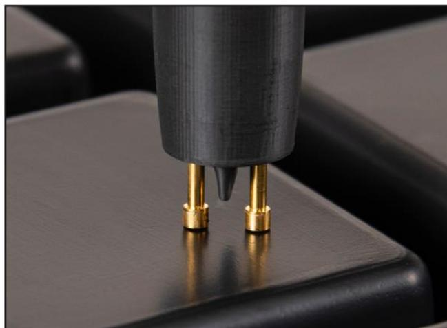
3. バネ式ピンをプローブのリミッターが物体表面に接触するまで押し当てます。
