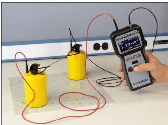
フロアタイルの Rtt を測定
