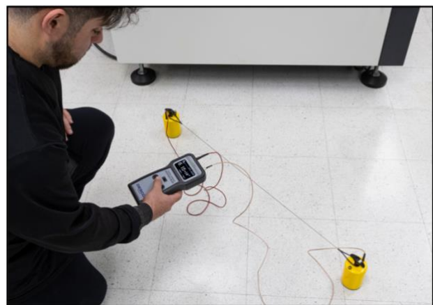
フロア素材の R_{tt} を測定
