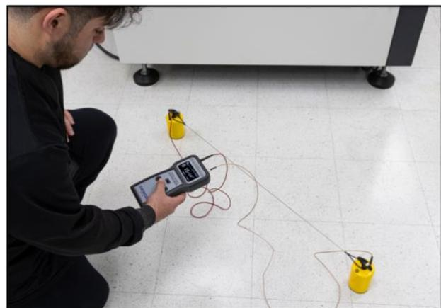
フロア素材の Rtt を測定
