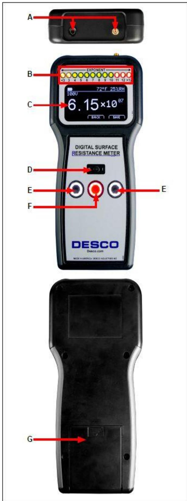
A. テスト用リード線差込口: 黒のテスト用リード線を本体の SMA コネクタに接続し、赤のテスト用リード線のバナナプラグを本体のバナナジャックに接続します。
