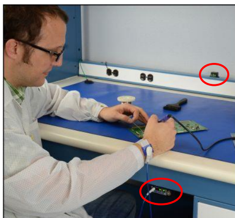
常時モニターとリモートアラームを作業台セットで使用している様子
