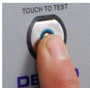
3. テストを始めるには、指で外側及び内側の両方のタッチスイッチに触れます。回転している青い光が止まると、テストが開始していることを示します。テスト結果が表示されるまで、指を保持したままにしてください。指を早く離しすぎると、テスターの LED が3回点滅して、テストが完了していないことを知らせます。テスト結果に影響を与えることになるため、テストを行っている間は他の金属に一切触れないでください。
