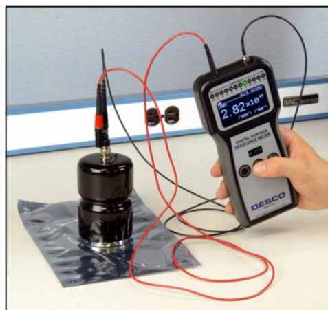
Desco デジタル表面抵抗測定器と接続
