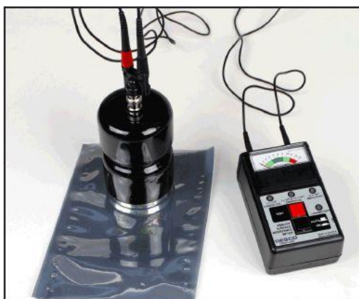
Desco アナログ表面抵抗測定器と接続
