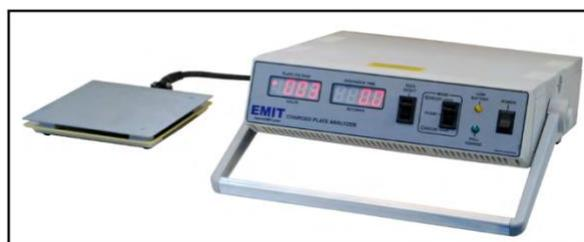
校正は、ESD 協会 除電基準 ANSU/ESD STM3.1 もしくは適合性検証 ESD TR53 に準拠して行わなければなりません。0.2MPa の圧力と 15cm の距離で、±1000V から ±100V への除電時間が 1 秒未満でオフセット電圧バランスが ±30V 以上である必要があります。
