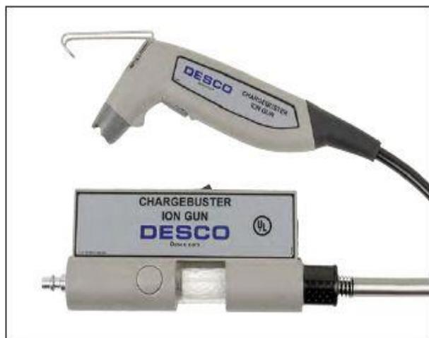
「静電気の管理では、製造装置内、限られた環境管理領域内または製品の一部からの異物の除去を促進させるためなど、限定された小さな領域や場所を静電気管理することが必要となることがあります。このような目的で使用するイオナイザは、発生したイオンを圧縮空気または窒素で目的物に送り込むブローオフタイプもしくはノズルタイプです。イオン発生は、放射線または電氣的なイオン化技術を使用しています。当然のことながら、作業領域に適した供給ガスのクリーン度や除電方法を選択することが非常に重要となります。」
