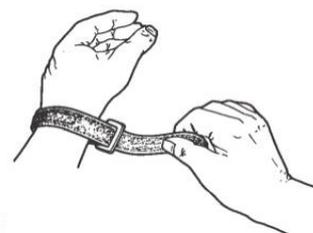
1. 黒の導電性バンドの側が皮膚に接触するようにリストストラップを手首に着けてください。
