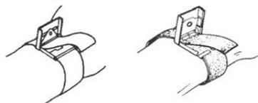
2. 留め金から素材の端部が出ているので、その上にある留め金を上方向に引っ張って開きます。
