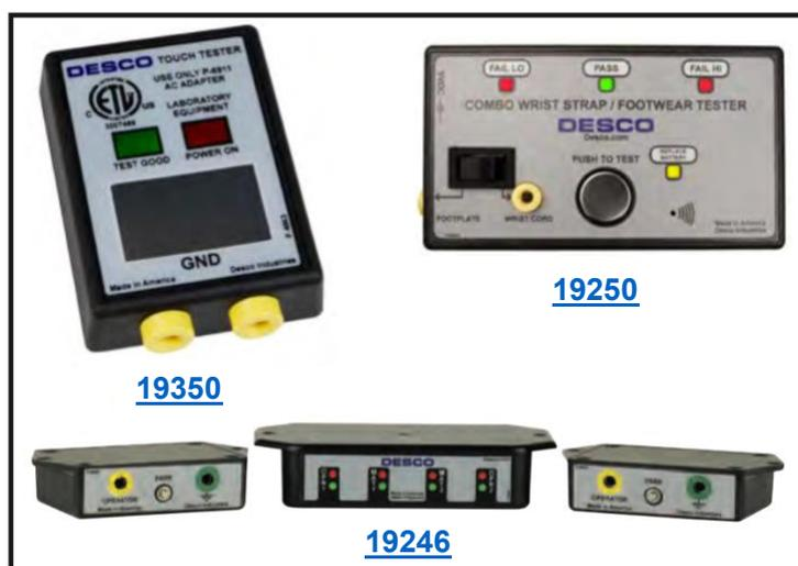
このような目的のために、DESCO にはリストストラップテスターが数種類あります。詳細は、品番ごとに技術図面又は技術パンフレットをご参照ください。テスターから上限または下限の測定値が得られる場合は、作業を中断し、リストバンドとコイルコードを個別に検査し、どちらに不具合があるのか確認してください。接触面と装着者の皮膚の状態を改善するために、手首の周りに静電気対策ローションを塗る必要がある場合もございます。不良の校正部品を交換し再度システムの検査を行ってください。「合格」を得てから作業を始めるようにしてください。
