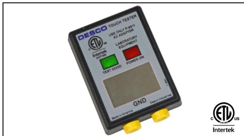
本製品は、「需要に応じた」リストストラップテスターであり、2 つのリストストラップとマットの共通接地ポイントとしても機能します。リストストラップの着用者がタッチテスターの表面の金属部に触れる時と、電流は着用者の肌からリストストラップを通過して、接地したテスターの金属部へと完全に流れていきます。この時、回路の抵抗が  $750\text{K}\Omega \sim 10\text{M}\Omega$  であれば、“合格”を示す緑 LED が点灯します(オプションで警報を鳴らすこともできます)。
