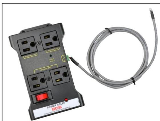
1. 付属のインターフェースケーブルの白色端子を WS Aware モニターの右側面にあるリレー端子に接続します。ケーブルの反対端をパワーリレーの緑色端子に接続します。
