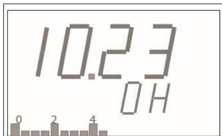
「Ohm」ボタンを押して、接地インピーダンスモードにします。左のような表示が出ます。インピーダンスモードの時は、ディスプレイの下部に「OH」と表示されます。
