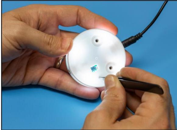
2. 付属の平ネジを使用して、2 つの磁石をモニターの底面に取り付けます。
