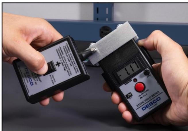
注意: チャージャーのタッチプレートとセンサーの基準接地間に接地経路を確保しなければなりません。通常は、片手でチャージャーを持ち、もう片方の手でチャージプレート付き静電気センサーを持つことで確保できます。
