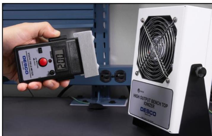
注意: パルス式イオナイザーをテストする場合、表示される電圧は常に変化します。実際の電圧変動はセンサーに表示される電圧よりも速い場合があるため、表示される電圧は実際の電圧の平均値となります。より正確な測定を行うには、静電気センサーの出力が役立ちます。
