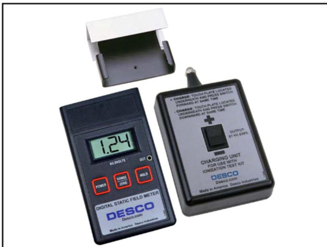
誤差が全くないわけではありませんが、電界電位測定器セットは、チャージプレートアナライザーと ANSI/ESD S3.1 を使用して行った測定に対応する測定を行うことができます。また、ANSI/ESD SP3.3「イオナイザーの定期的な検査」または ESD TR53「適合性検証」に準拠してテストを行うための便利で携帯可能な機器です。より正確な測定が必要な場合はチャージプレートアナライザーの使用をお勧め致します。
