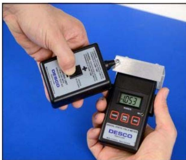
**重要:**チャージャーのタッチボタンと測定器の基準接地間に接地経路を確保しなければなりません。通常は、片手でチャージャーを持ち、もう片方の手で導電性プレート付き電界電位測定器を持つことで確保されます。
