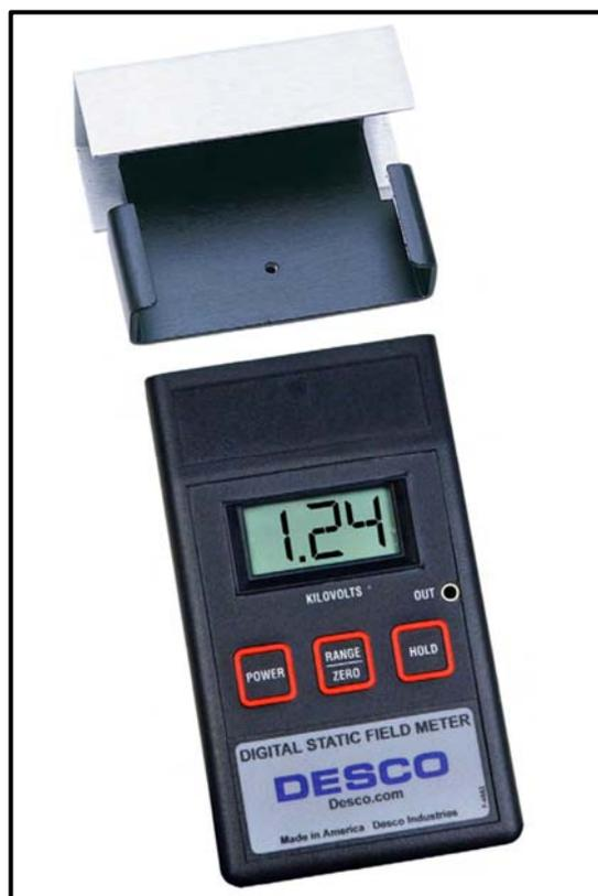
**注意:** パルス式イオナイザーを測定する際は、表示される電圧は絶えず変化しています。このパルス周波数は、静電気測定器の表示される数値が更新される速度よりも速くなりますので、表示される電圧は、実際の電圧の平均となります。この状態では、電界電位測定器の出力はより正確な測定に役立ちます。
