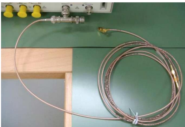
図 3: 50Ω 負荷に接続された RF ケーブル
