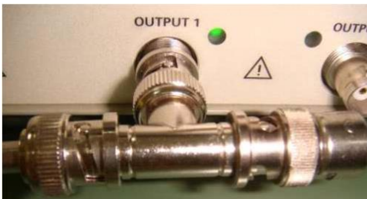
図 2: 50 \Omega の負荷をパルス発生器の出力 1 に接続
