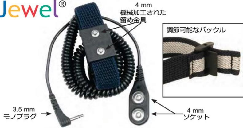
デュアルワイヤー式リストストラップは2重接地経路を持ち、片方の経路が切断した場合でも残りの1本により、確実に接地経路を確保します。
